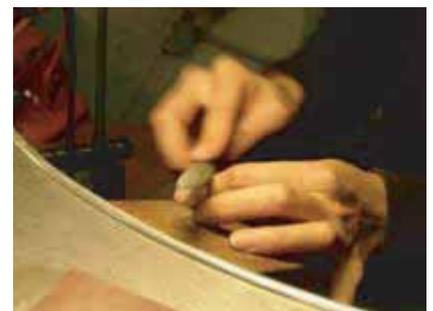
ここからは鑢でひたすら磨きます。最初は目の粗い棒状の鑢で表面をしっかりとらし、電動の鑢でさらに磨きをかけていきます。鑢の目をどんどん細かいものに変えていき、表面も内側もしっかりと磨きます。
